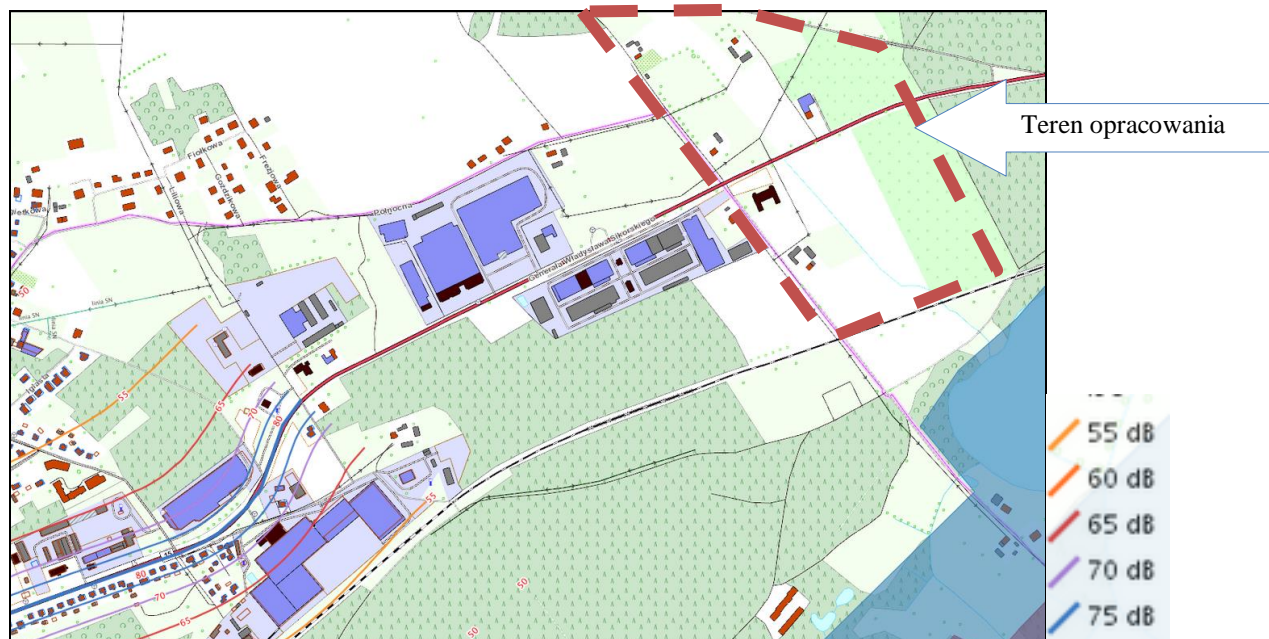
Rysunek 11 Mapa emisyjna dla LDWN -długookresowy średni poziom dźwięku A wyrażony w decybelach (dB), wyznaczony w ciągu wszystkich dób w roku, z uwzględnieniem pory dnia.
